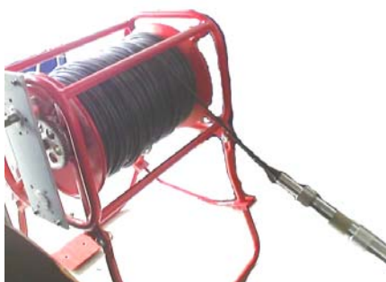
接收探头与绞车连接示意图
